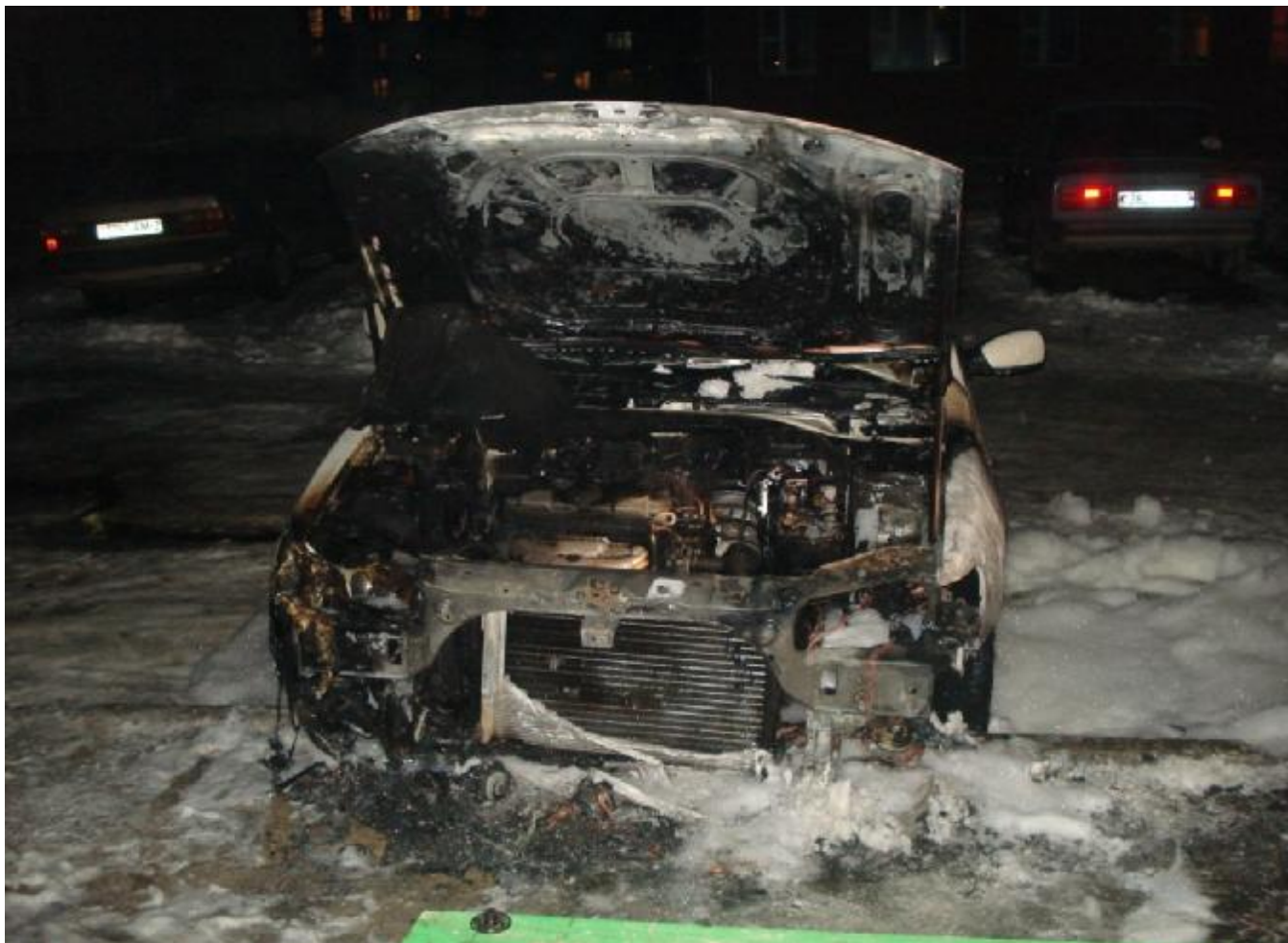
Пожар автомобиля «Пежо 306», находившегося на временной стоянке во дворе жилого дома по ул. Дзержинского, 9. Причина возникновения пожара нарушение правил эксплуатации электрических сетей и электрооборудования автомобиля.
